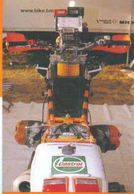
Der Luftfilter sitzt oben hinter dem Steuerkopf
