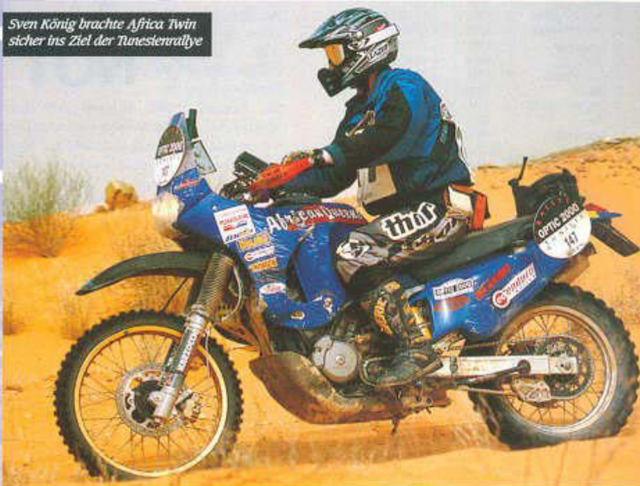
Der Alu-Kühlerschutz bildet eine Einheit mit dem Rallye-Vorbau.
