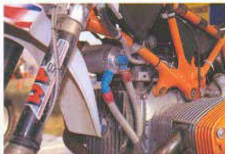
Der Ölfilter wurde an den Rahmen hochgezogen
