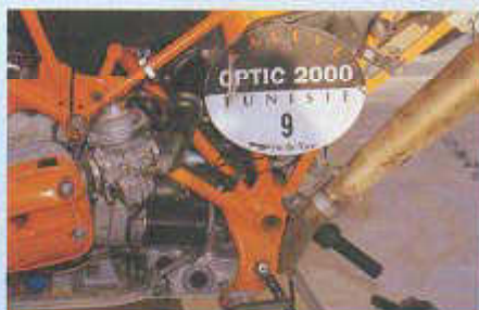
Der Chrom-Molybdänstahl-Gitterrohrrahmen ist eine HPN-Eigenkonstruktion
