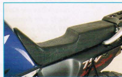
SW Mo-Tech polstert die Original-Sitzbank zur abgestuften Touring-Version um. Breiter und straffer als die serienmäßige Folterbank, fängt das entspannte Sitzen bei 669 Mark an.
