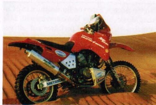
Alu-Heck, Transalp-Tank, Rallye-Verkleidung und White-Power-Fahrwerk: So ist die RD 04 gut gerüstet.
