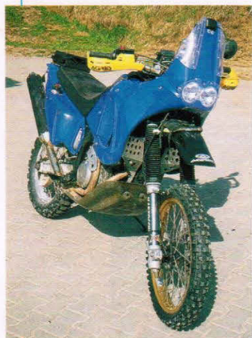
56-Liter-Tank (1.899 DM) und einteilige Verkleidung (999 DM) werden aus GfK gefertigt (o.). Darunter ein Rallye-Umbau, wie er auch bei der Tunesien-Rallye zum Einsatz kam, hier allerdings mit 35 Liter fassendem Zweikammer-Tank.
