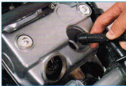
Das Bordwerkzeug sollte man vor der Tour austauschen. Die Einstellung des Auslaßventils (L) des hinteren Zylinders bereitet am wenigsten Probleme.
