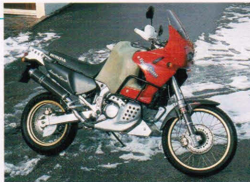
Touren-Umbau mit 45-Liter-Tank (1.599 DM) und einteiliger Verkleidung.
