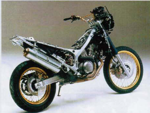
Stabilerer Rahmen, Massen näher am Schwerpunkt, weniger Gewicht gepaart mit viel Rallye-Flair: die RD 07.
