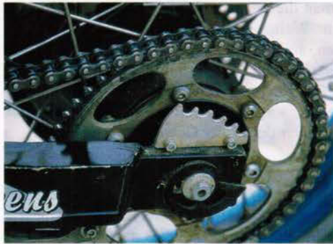
Abgekupfert: Die an der Schwinge montierte Kettenablage haben wir erstmals an der KTM 950 gesehen. Geklaute Idee, aber beim Rad-ausbau äußerst hilfreich (l.).
