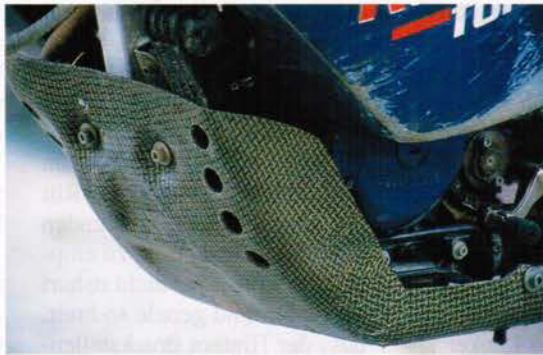
Ein ultraleichter Carbon-Schutz hält das Größte vom Motor fern. Die Kampfspuren an den Seitentanks haben übrigens nicht wir verursacht.
