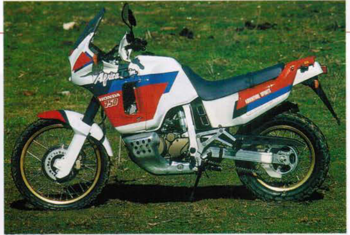
► 1990, RD 04: 742 cc (81x72 mm), 60 CV a 7.500 giri/min, peso 210 kg, prezzo: 11.385.000 lire. Miglioramenti: coppia, comportamento stradale, comfort. Peggioramenti: peso, avantreno troppo carico, baricentro alto, guida fuoristrada, serbatoio da 24 l anziché 25.
