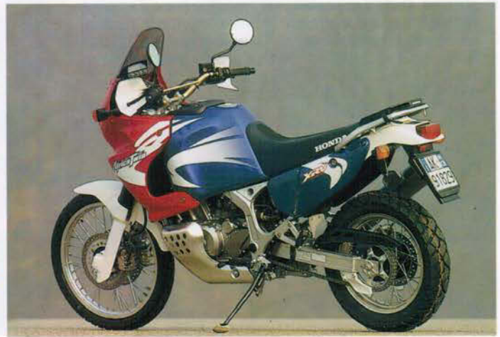
► 1996, RD 07A: 742 cc, 60 CV a 7.500 giri, peso 205 kg, prezzo (nel 2002) 9.250 euro. Miglioramenti: fari, sella più comoda, consumo. Peggioramenti: pompa benzina delicata, sospensioni non regolabili, cerchi non anodizzati. Per tutte: regolatore di tensione debole.
