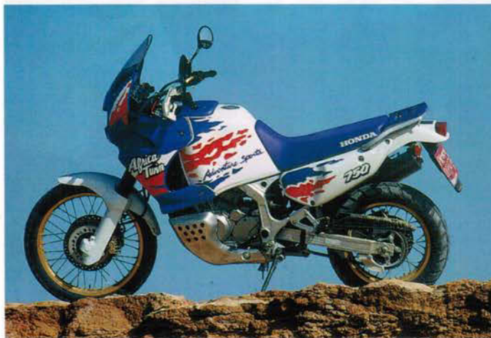
► 1993, RD 07: 742 cc, 62 CV a 7.500 giri/min, peso 202 kg, prezzo 11.829.000 lire. Miglioramenti: peso e baricentro abbassati, filtro aria alto e accessibile, sospensioni regolabili. Peggioramenti: sella più scomoda, luce a terra, serbatoio da 23 l, assenza spia riserva.
