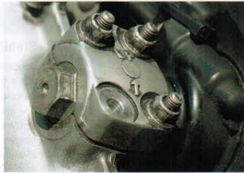
Nach »fest« kommt »ab«: An der Gabelklemmung (unter der Tauchrohrabdeckung) reißt bei zu hohem Drehmoment gern mal einer der eingeschaubten Gewindebolzen ab.
