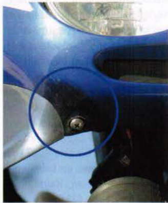
Hinweis auf kaschierten Umfaller oder Sturz: eine gerissene und geflickte Verschraubungslasche zwischen Lampenmaske und Seitenverkleidung, hier an einer RD07.
