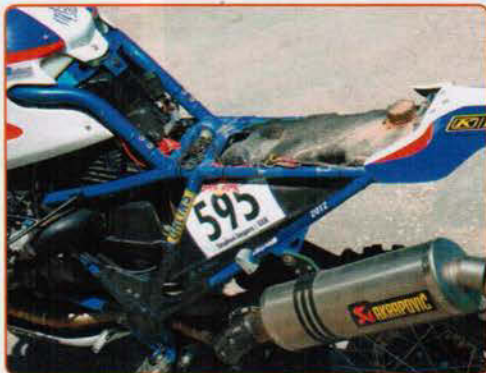
Perfekt im Heck eingebetteter 7,1 Liter fassender Polyethylen-Zusatztank
